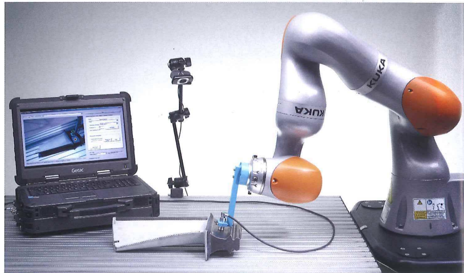
AR-System zur manuellen oder roboterunterstützten Prüfung von Bauteilen oder großen Oberflächen. © Fraunhofer IZFP
