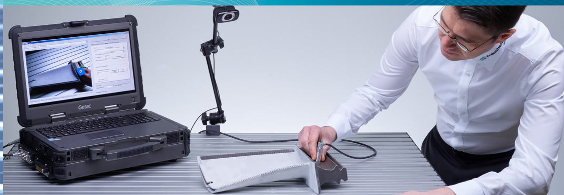
Mit 3D-SmartInspect in die digitale ZfP-Welt: Augmented Reality-System zur manuellen Prüfung von Bauteilen oder großen Oberflächen
