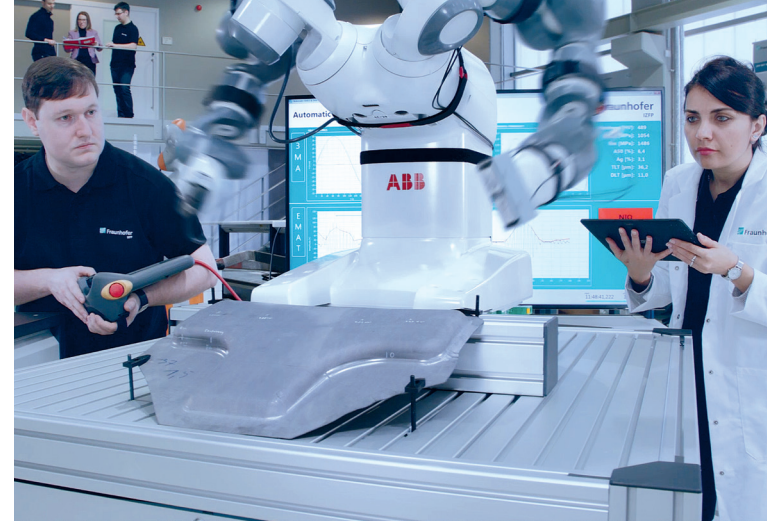
Mitte: Aktive Thermographie zur Oberflächenrisserkennung; rechts: 3MA-II-System zur Erfassung von mikromagnetischen Werkstoffeigenschaften und -kenngrößen
