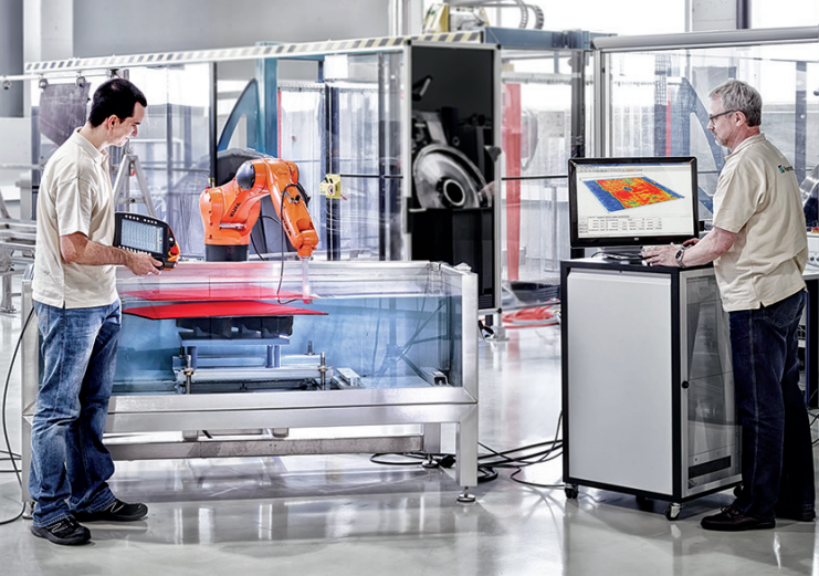
Prüfung von CFK-Komponenten mit Sampling Phased Array
