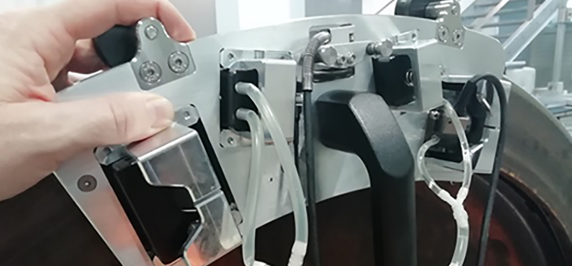
Handscanner zur Wellen-, Spurkranz- und Laufflächenprüfung
