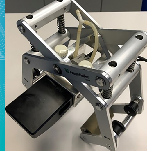
PASAWIS – mobil in der Produktion einsetzbares Radsatzprüfsystem
