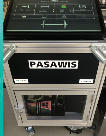
PASAWIS – mobil in der Produktion einsetzbares Radsatzprüfsystem
