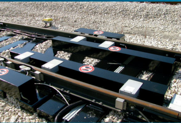
Links: Moderne Ausführungsform eines AUROPA-Inspektionsgleises; rechts: Eisenbahnrad auf EMUS-Prüfkopf im Überrollbetrieb
