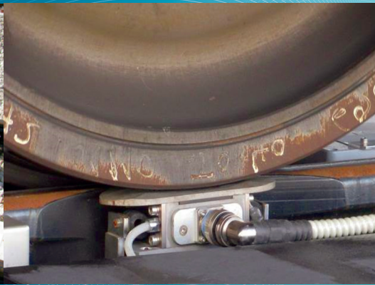
Links: Moderne Ausführungsform eines AUROPA-Inspektionsgleises; rechts: Eisenbahnrad auf EMUS-Prüfkopf im Überrollbetrieb
