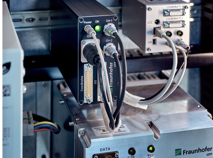
Links: Mit 3D-SmartInspect in die digitale ZfP-Welt: AR-System zur manuellen Bauteilprüfung mit automatischer Dokumentation in DICONDE
