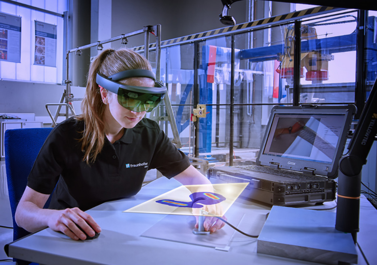
Links: Mit 3D-SmartInspect in die digitale ZfP-Welt: AR-System zur manuellen Bauteilprüfung mit automatischer Dokumentation in DICONDE
