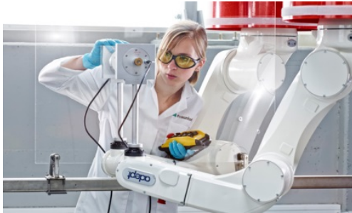
Luftultraschall: Ein mit dem Ultraschall-Prüfsystem verbundener Industrieroboter tastet das Bauteil ab. © Uwe Bellhäuser
